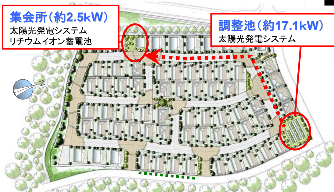
■ 調整池上部の太陽光発電システムと自営線による直流送電
