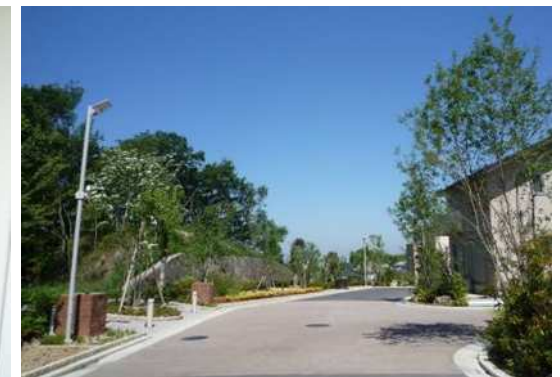
■ 消費電力が少なく、 長寿命なLED街路灯 (集会所の蓄電池から 電力供給)
